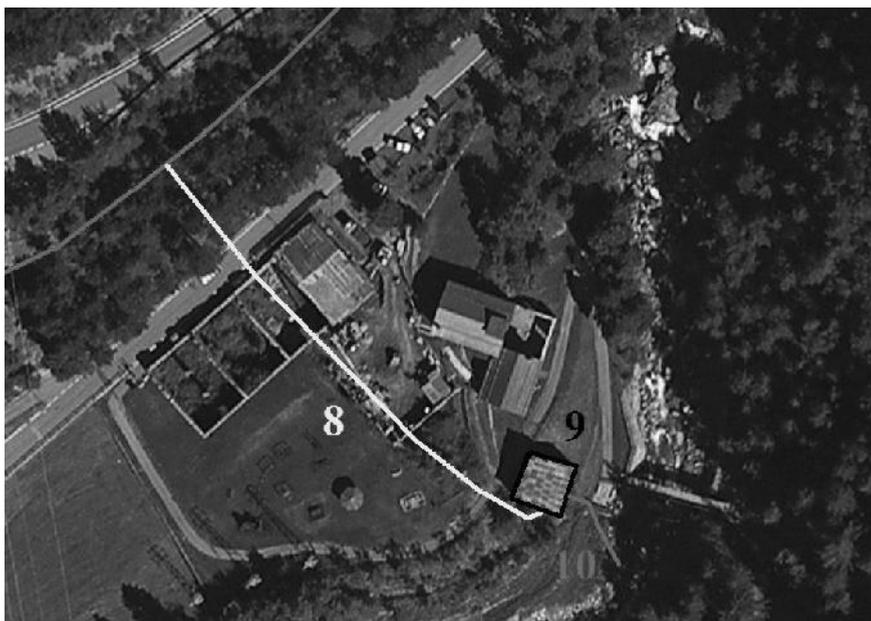
*Figura 22 - Percorso condotta forzata con centralina e opere di restituzione*
