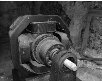
Figura 40 - Dinamo con pali statorici avvolti
