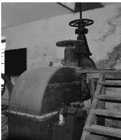
Figura 30 - Copertura della turbina con doppia valvola di regolazione
